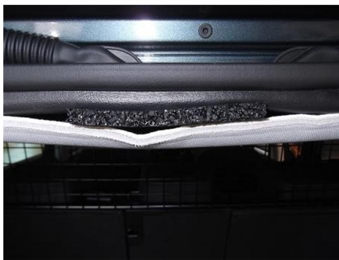
Im oberen Bereich der Hecktür die Gummiabdichtung leicht anheben und je nach gewünschter Position des Teilers die 2 Gummiunterlagen 8mm (Pos.8) im Bereich des Feststellpunktes in den Hohlraum schieben.
