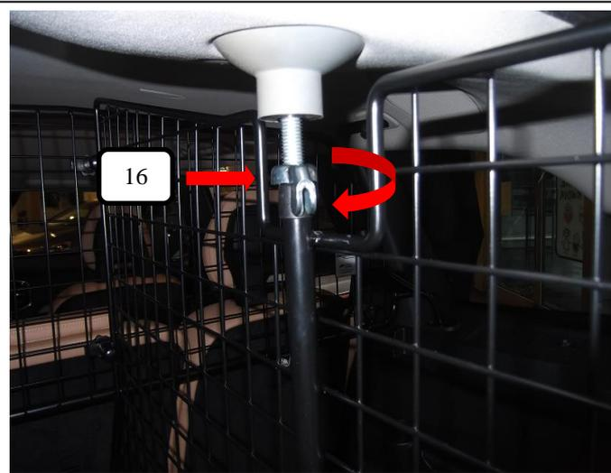
Oberen Feststellpunkt über drehen der Flügelmutter (Pos. 16) (Uhrzeigersinn) leicht anziehen.
