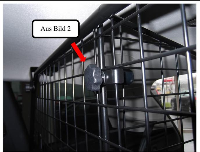
Den Teiler (Pos. 1) mittels der beiden Verschraubungen aus Bild 2 oben und unten am Trenngitter befestigen.
