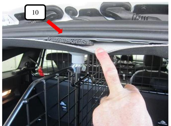
Im oberen Bereich der Hecktür die Gummiabdichtung leicht anheben und je nach gewünschter Position des Teilers 2 Stück der Gummimatte 8mm (Pos.10) im Bereich des Feststellpunktes in den Hohlraum schieben.
