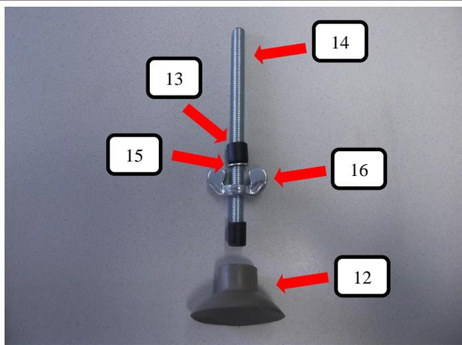
Die Gewindestange (Pos.14) auf einen Gummifuß grau (Pos.12) wie im Bild dargestellt aufstecken. Danach die Flügelmutter (Pos. 16) aufschrauben und die Unterlegscheibe (Pos. 15), sowie die Distanzhülse (Pos. 13) aufstecken.
