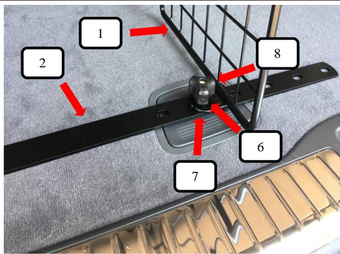
Teiler (Pos. 1) in das Fahrzeug einbringen, gewünschte Position auswählen und auf den Bodenhalter (Pos. 2) stellen. Von unten eine Schlossschraube (Pos. 7) durch den Bodenhalter (Pos. 2) und Teiler (Pos. 1) stecken, jetzt von oben eine Unterlegscheibe (Pos. 6) und Rändelmutter flach (Pos. 8) aufschrauben und festziehen.
