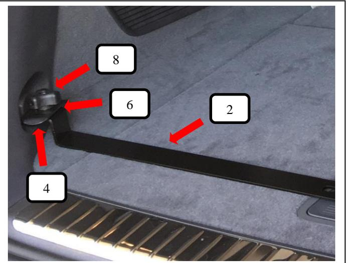
Bodenhalter (Pos. 2) von unten mit dem Gewinde durch die Verzuröse führen, von oben die Gegenplatte (Pos. 4), sowie Unterlegscheibe (Pos. 6) über das Gewinde führen und mit einer Rändelmutter flach (Pos. 8) aufschrauben und festziehen.
