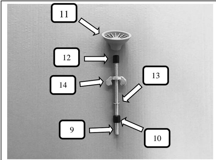
Die Gewindestange oben (Pos.9) mit der Distanzhülse (Pos. 12), in den Gummifuß grau (Pos.11) wie im Bild dargestellt aufstecken. Danach die Flügelmutter (Pos. 14) aufschrauben und die Unterscheibe (Pos. 13), sowie die Durchführungsschutzkappe (Pos. 10) aufstecken.
