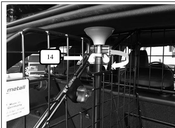
Oberen Feststellpunkt mittel drehen der Flügelmutter (Pos. 14) (Uhrzeigersinn) leicht anziehen.
