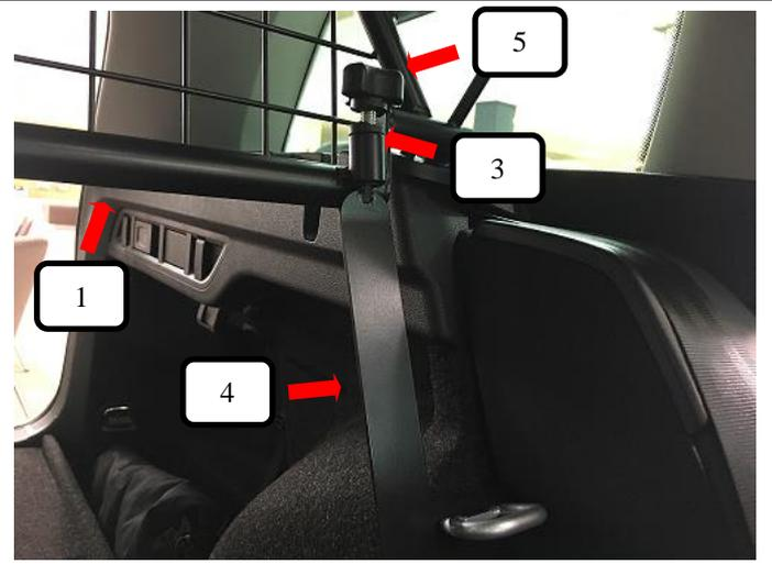
Gewindehaken (Pos. 4) über die Rücksitzbankkarretierung schieben und dann nach oben mit dem Gewinde durch das Trenngitter (Pos. 1) sowie Kunststoffhülse (Pos. 3) stecken. Jetzt eine Rändelmutter (Pos. 5) aufschrauben und festziehen.
