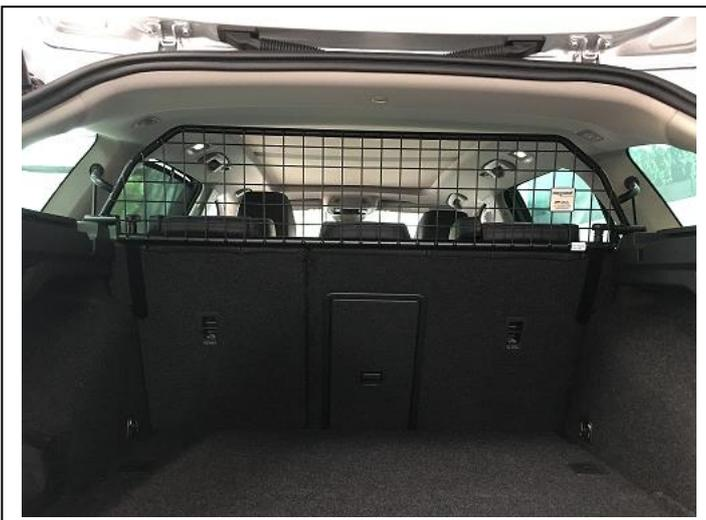
Trenngitter im montierten Zustand.
