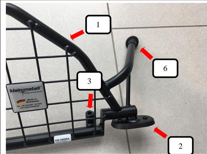
Gummifuß 25° (Pos. 6) sowie Gummiauflage groß (Pos. 2) auf das Trenngitter (Pos. 1) und Kunststoffhülse (Pos. 3) in das Trenngitter (Pos. 1) stecken.
