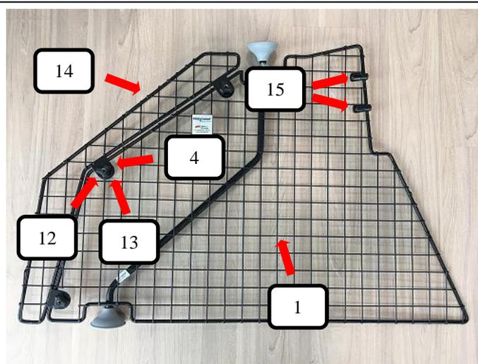
Aufsatz Teiler (Pos. 14) an allen drei Positionen mit einer Schlossschraube (Pos. 12), Unterlegscheibe (Pos. 4) und Rändelmutter flach (Pos. 13) am Teiler (Pos. 1) wie auf Bild 3 aufschrauben und festziehen. Rohrendkappen (Pos. 15) aufstecken.
