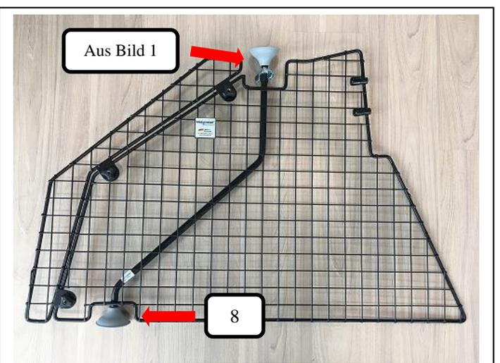
Wie im Bild dargestellt bitte die aus Bild 1 zusammengesteckte Gewindestange mit Gummifuß oben in die Rohröffnung des Teilers stecken (Feststellpunkt) und einen Gummifuß (Pos.8) unten am Teiler aufstecken.
