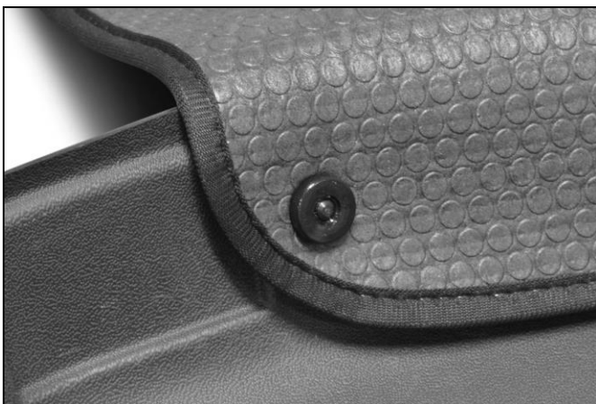
Detail van kunststof kartelschroef + moer.
