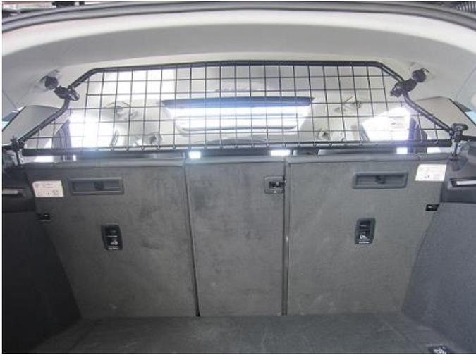
Trenngitter im montierten Zustand.
