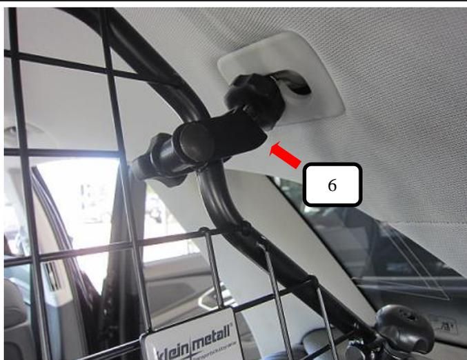
Halterung FS301A (Pos. 6) wie auf dem Bild in die vorhandenen Netzaufhängungen im Fahrzeug einhängen und mit der Rändelmutter anziehen. Die vorhandene Schlossschraube durch die Halterung FS301A und das Trenngitter (Pos.1) stecken und von der anderen Seite mit einer Unterlegscheibe und Rändelmutter aufschrauben und festziehen.
