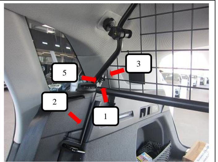
Gewindehaken (Pos. 2) über die Rücksitzbankverankerung schieben und durch das Trenngitter (Pos. 1) und die Kunststoffhülse (Pos. 5) stecken. Jetzt die Rändelmutter gewölbt (Pos. 3) aufschrauben und festziehen.
