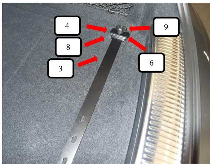
Schlossschraube (Pos. 8) von unten durch den Bodenhalter (Pos. 3) stecken, jetzt die Verzuröse im Kofferraums etwas nach oben klappen und den Bodenhalter (Pos. 3) darunter halten. Von oben die Gegenplatte (Pos. 4) drauflegen, mit der Unterlegscheibe (Pos. 6) und Rändelmutter flach (Pos. 9) festziehen.
