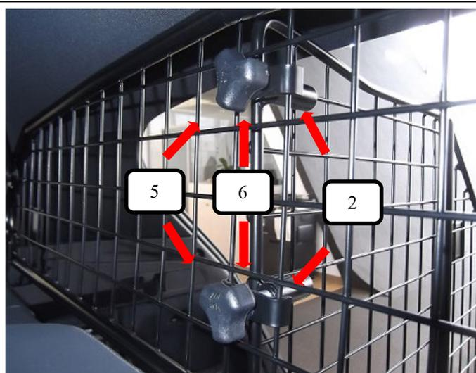
Die beiden U-Bügel (Pos. 2) zusammen von vorne mit jeweils einer Unterlegscheibe (Pos. 6) und Rändelschraube (Pos. 5), oben und unten am Trenngitter befestigen.
