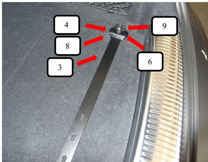
Schlossschraube (Pos. 8) von unten durch den Bodenhalter (Pos. 3) stecken, jetzt die Verzurröse im Kofferraum etwas nach oben klappen und den Bodenhalter (Pos. 3) darunter halten. Von oben die Gegenplatte (Pos. 4) drauflegen, mit der Unterlegscheibe (Pos. 6) und Rändelmutter flach (Pos. 9) festziehen.
