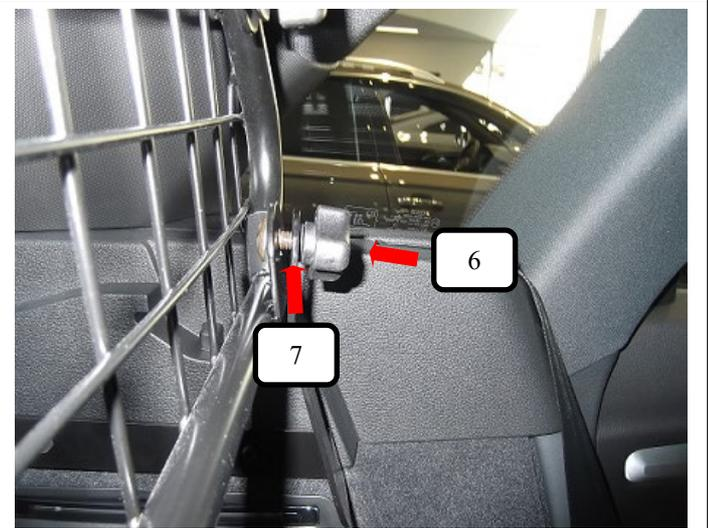
Jetzt von vorne mit der Unterlegscheibe (Pos. 7) und der Rändelmutter flach (Pos. 6) aufschrauben und festziehen.
