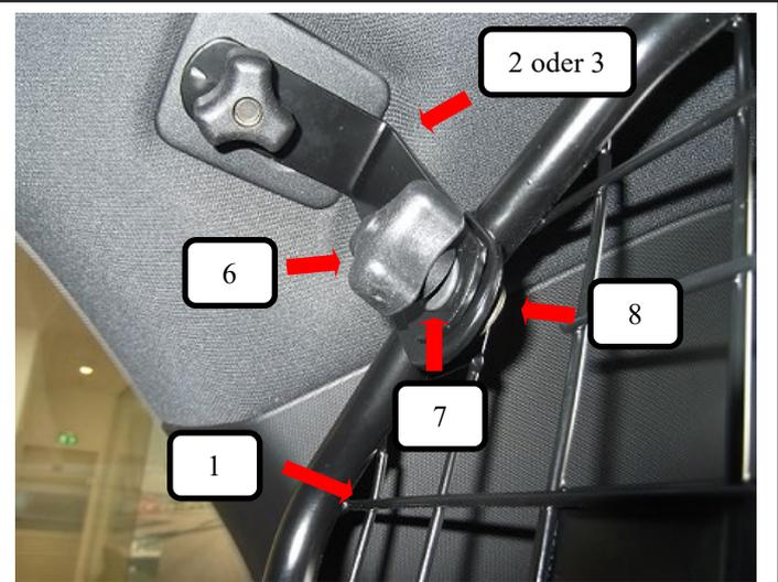
Das Trenngitter (Pos. 1) an den Dachhalter (Pos. 2 oder 3) halten und die Schlossschraube (Pos. 8) von hinten durchstecken. Von der anderen Seite mit der Unterlegscheibe (Pos. 7) und die Rändelmutter flach (Pos. 6) aufschrauben und festziehen.
