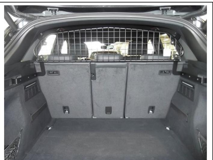
Trenngitter im montierten Zustand.
