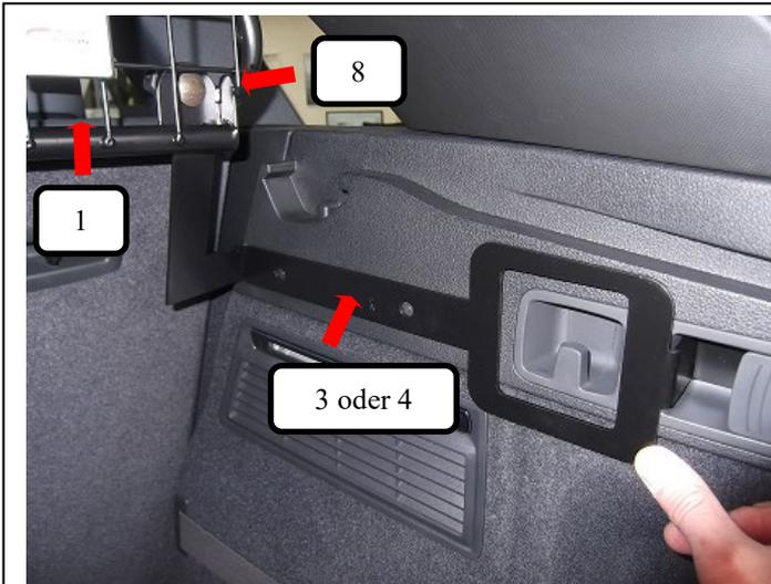
Seitenhalter rechts + links – lang oder kurz (Pos. 4 oder 5) auf beiden Seiten von vorne an das Trenngitter (Pos. 1) halten und von hinten die Schlossschraube (Pos. 8) durchstecken.
