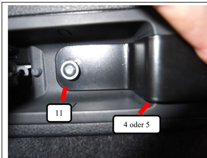
Hebel zurückziehen und Plastikkappe entfernen, darunter befindet sich eine Schraube die mit einem Torx T15 rausgedreht werden muss. Jetzt die Seitenhalter rechts + links – lang oder kurz (Pos. 4 oder 5) ran drücken und mit den Innensechskantschrauben (Pos. 11) festschrauben. Benötigtes Werkzeug: Inbus Gr.3 und Torx Gr. T15
