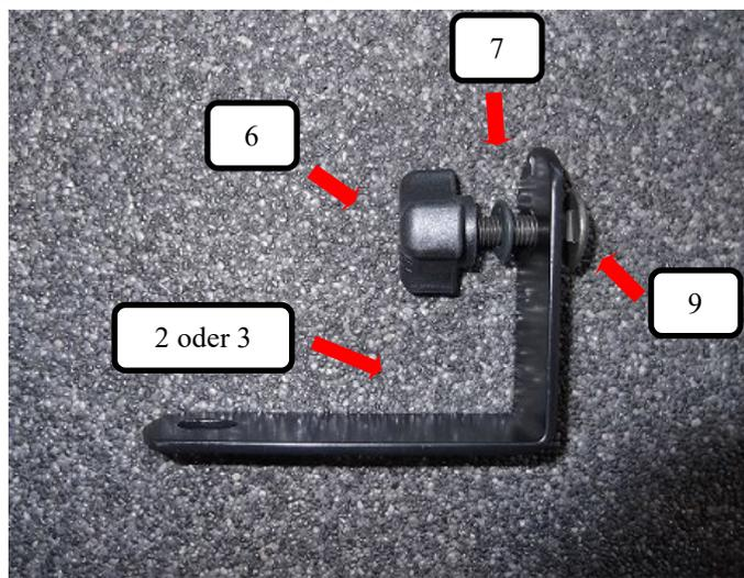
Je nach Ausstattungsvariante der Rücksitzbank (mit oder ohne Komfort-Plus), muss der Dachhalter (Pos. 4 oder 5) mit der Schlossschraube (Pos. 8), Unterlegscheibe (Pos. 7) und der Rändelmutter flach (Pos. 6) vormontiert werden.
