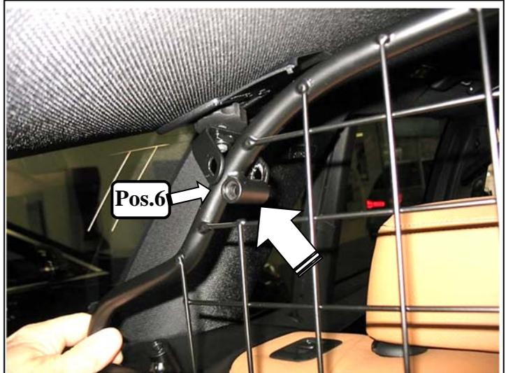
Trenngitter in das Fahrzeug einbringen und zwischen die Aufnahmen schieben.
