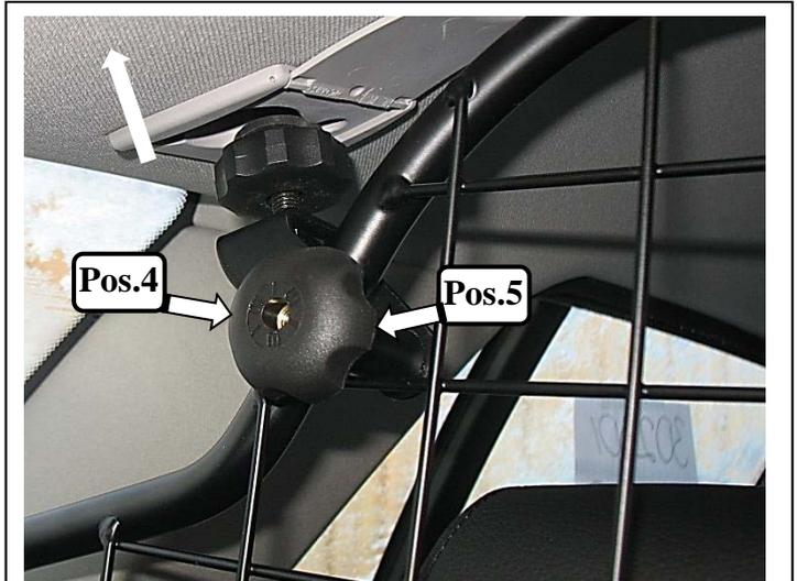
Mit Unterlegscheibe (Pos.5) und Rändelmutter (Pos.4) fixieren.
