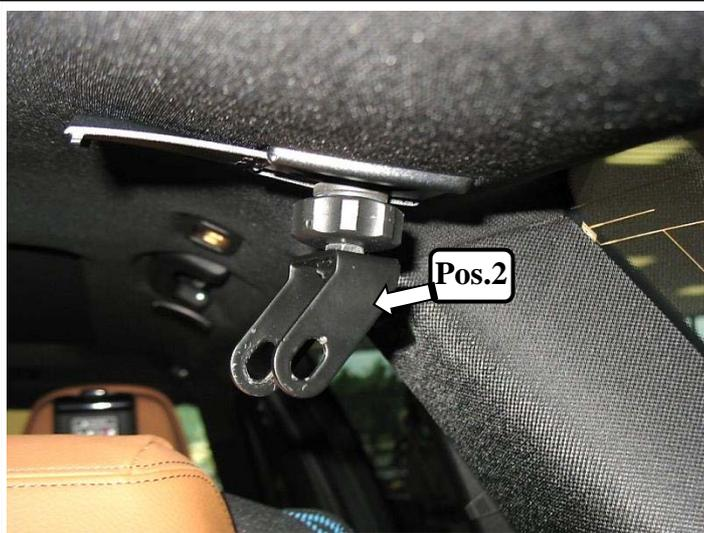
Klappen am Fahrzeugdach öffnen, Dachaufnahme (Pos.2) einhängen und mit Rändelmutter leicht fixieren.
