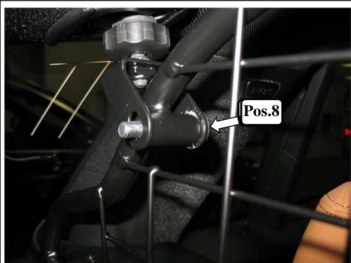
Rundkopfschraube (Pos.7) einsetzen.
