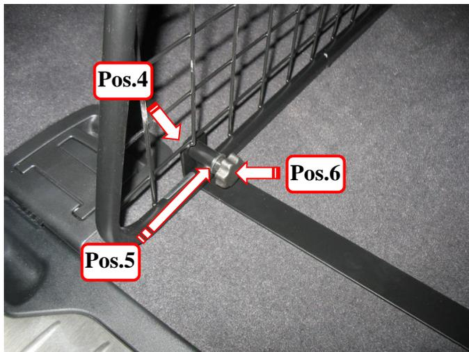
Schlossschraube (Pos. 4) von links durch den Teiler (Pos. 1) und den ausgewählten Bodenhalter (Pos. 7 oder 8) stecken, jetzt von der anderen Seite eine Unterlegscheibe (Pos. 5) und Rändelmutter (pos. 6) aufschrauben und festziehen.
