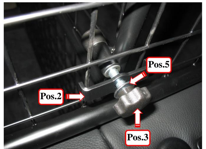
U-Bügel (Pos. 2) wie auf dem Bild 6 mittels Unterlegscheibe (Pos. 5) und Rändelschraube (Pos. 3) fixieren und festziehen.
