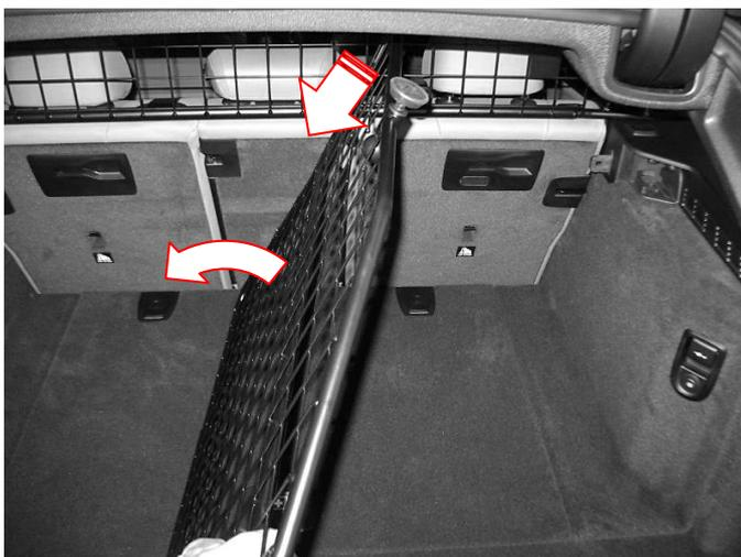
Teiler wie auf dem Bild 3 in das Fahrzeug einbringen und senkrecht stellen.
