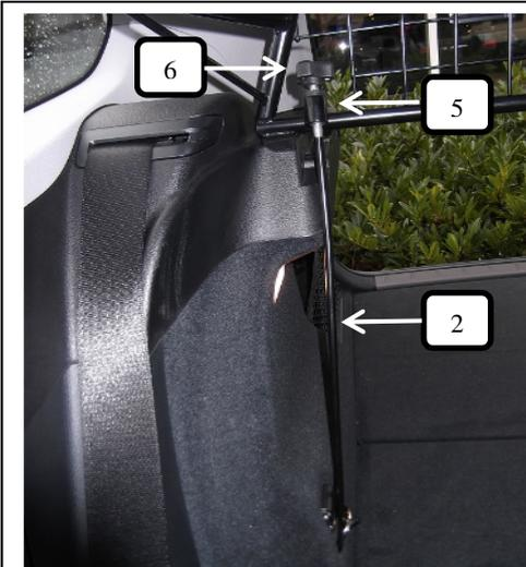
Den Gewindehaken (Pos.2) jeweils rechts und links in die untere Verzurrösenhalterung einhängen durch die Kunststoffhülse (Pos.5) am Trenngitter führen, Trenngitter ausrichten und mit der Rändelmutter (Pos.6) befestigen.
