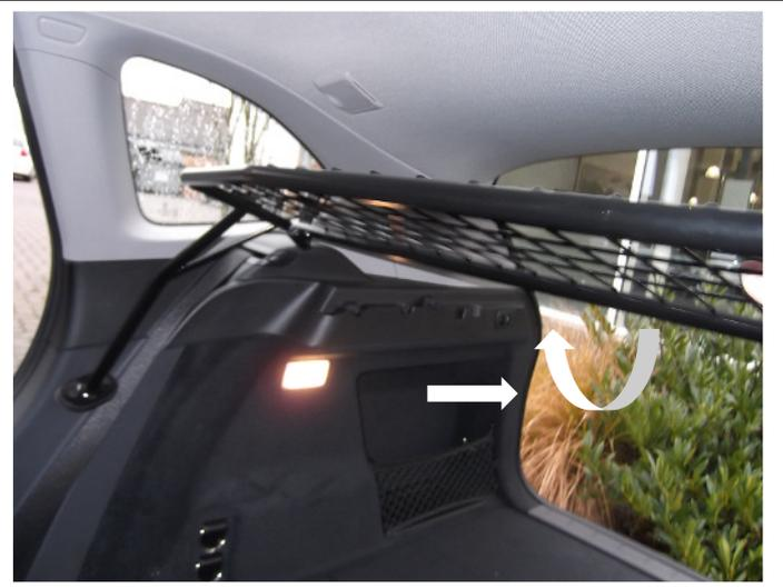
Trenngitter von der Rücksitzbank aus waagrecht mit den Streben nach unten in den Kofferraum des Fahrzeuges bringen, senkrecht aufstellen so dass die Gummiauflage groß sich rechts und links an der C-Säule und die Gummiauflage klein auf der Kunststoffverkleidung der Kofferraumabdeckung abstützen kann.
