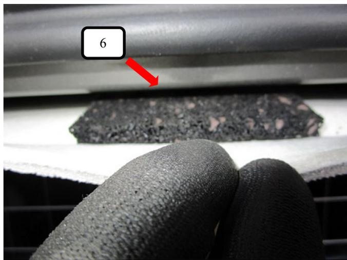
Im oberen Bereich der Hecktür die Gummiabdichtung leicht anheben und je nach gewünschter Position des Teilers die beigelegten Gummimunterlagen 8mm (Pos.6) im Bereich des Feststellpunktes in den Hohlraum schieben.
