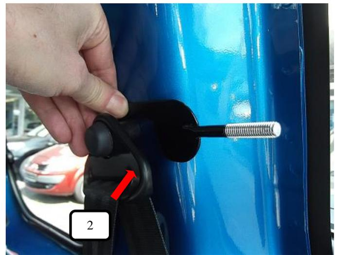
Gewindehaken (Pos. 2) an der Gurthalterung einhängen.
