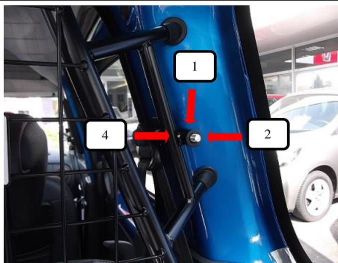
Trenngitter (Pos. 1) in das Fahrzeug heben, den Gewindehaken (Pos. 2) durch das Trenngitter (Pos. 1) und Kunststoffhülse (Pos. 4) stecken.
