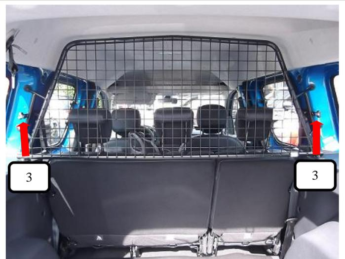
Rändelmutter (Pos. 3) drauf drehen und festziehen, jetzt ist das Trenngitter im Fahrzeug fertig montiert.
