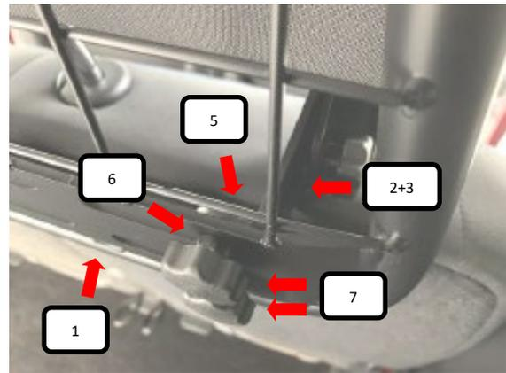
Jetzt das Trenngitter (Pos. 1) vor die montierte Winkelstütze Haken + Klemmbacke (Pos. 2+3) an der äußeren Kopfstütze halten, von vorne eine Rundkopfschraube (Pos. 5) durch die Winkelstütze (Pos. 2+3) und das Trenngitter (Pos. 1) stecken. Jetzt von der anderen Seite eine Unterlegscheibe (Pos. 6) und Rändelmutter (Pos. 7) aufschrauben und festziehen. An der mittleren Kopfstütze ist die gleiche Montage wie auf Bild 4 zu machen.
