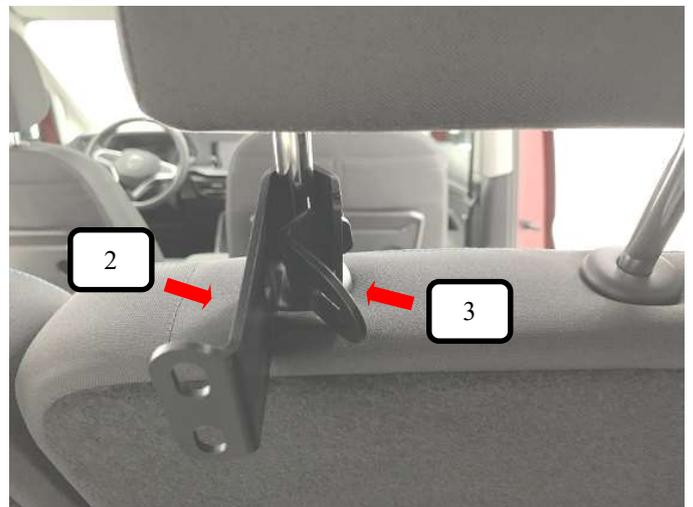
Winkelstütze Haken (Pos. 2) wie auf dem Bild um die Kopfstützenstangen führen, jetzt die Winkelstütze Klemmbacke (Pos. 3) in die Winkelstütze Haken (Pos. 2) einklinken.
