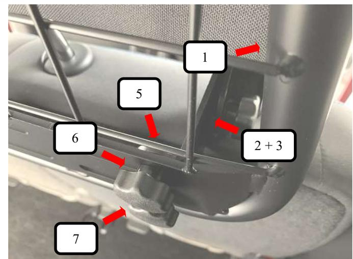
Jetzt das Trenngitter (Pos. 1) vor die montierte Winkelstütze (Pos. 2+3) halten, von vorne eine Rundkopfschraube (Pos. 5) durch die Winkelstütze (Pos. 2+3) und das Trenngitter (Pos. 1) stecken. Jetzt von der anderen Seite eine Unterlegscheibe (Pos. 6) und Rändelmutter (Pos. 7) aufschrauben und festziehen.
