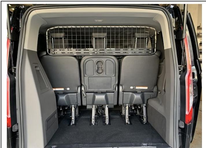
Trenngitter im montierten Zustand.
