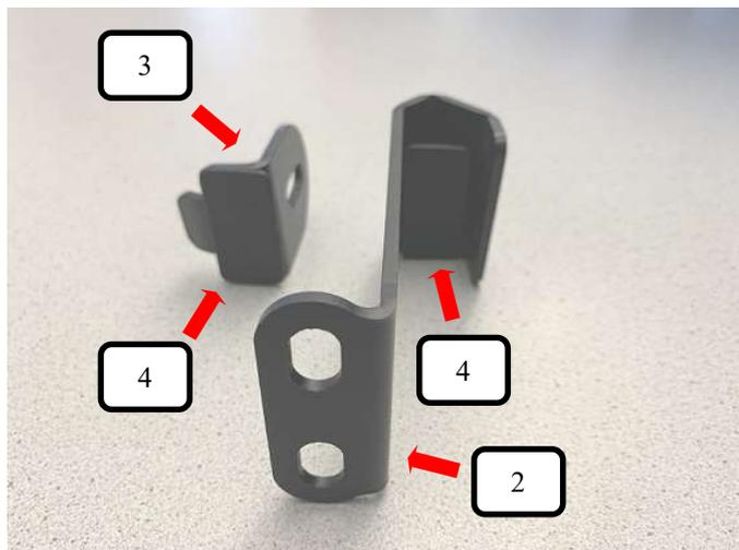
Winkelstütze Haken (Pos. 2) und Winkelstütze Klemmbacke (Pos. 3) wie auf dem Bild mit einer Gummiauflage (Pos. 4) versehen.
