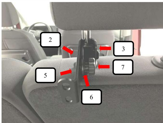
Eine Rundkopfschraube (Pos. 5) durch die Winkelstützen (Pos. 2 + 3) stecken und von der anderen Seite eine Unterlegscheibe (Pos. 6) und eine Rändelmutter (Pos. 7) aufschrauben und festziehen. Darauf achten das alle drei Halterungen nach der Montage gerade ausgerichtet sind.
