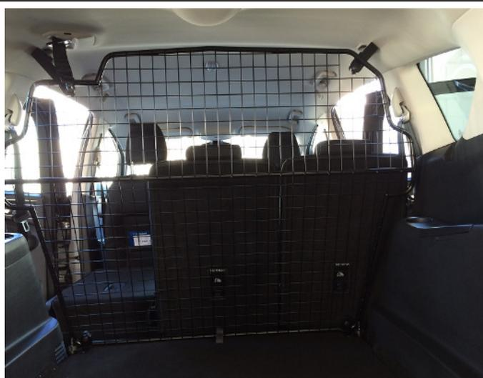
Trenngitter nochmals ausrichten und alle Befestigungen final anziehen und Rücksitze wieder hochklappen.
