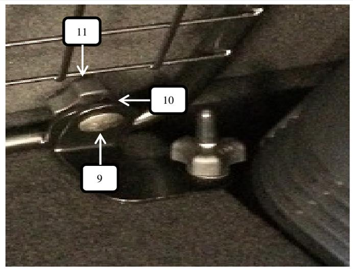
Trenngitter an den Winkeln unten mit der Schlossschraube (Pos.9), Unterlegscheibe (Pos.10) und einer Rändelmutter flach (Pos.11) befestigen.
