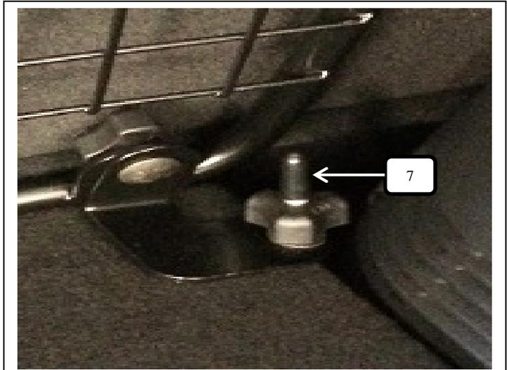
Die in Bild 2 zusammengebauten Winkel im vorhandenen Ladehacken unter Bodenabdeckung einhängen und leicht anziehen, und die Schutzkappen (Pos.7) über das überstehende Gewinde stecken
