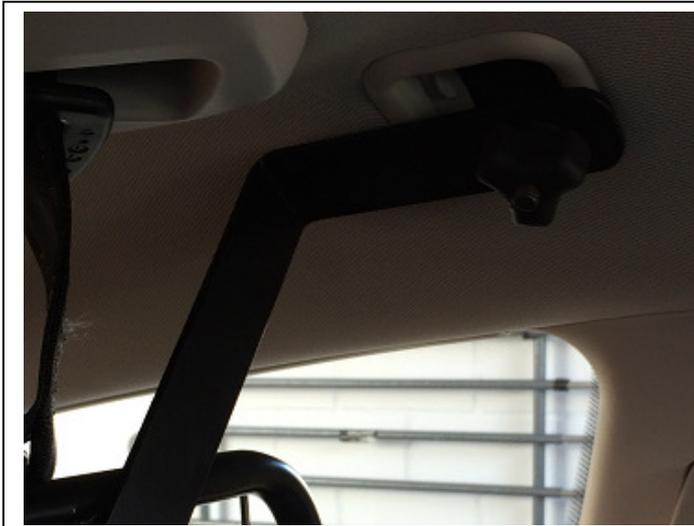
Die in Bild 1 zusammengebauten Winkel oben in die Netzaufhängung einhängen und leicht anziehen
