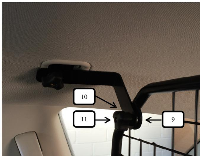
Trenngitter vom Kofferraum aus ins Fahrzeug bringen und an den Winkeln oben mit der Schlossschraube (Pos.9), Unterlegscheibe (Pos.10) und einer Rändelmutter flach (Pos.11) befestigen.
