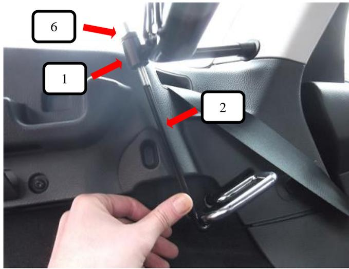
Gewindehaken (Pos. 2) jeweils rechts und links, durch die Kunststoffhülsen (Pos. 6) am Trenngitter (Pos. 1) stecken und unten an der Halterung einhängen.
