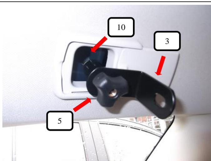
Die auf Bild 1 vormontierten Dachhalter (Pos. 3) mit der Schlossschraube (Pos. 10), in die im Dach enthaltenen Netzaufhängungen (rechts + links) eingehängen und mit der Rändelmutter flach (Pos. 5) festziehen.
