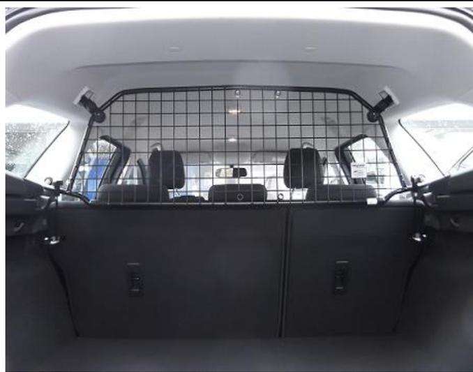
Trenngitter (Pos. 1) im fertig montierten Zustand.
