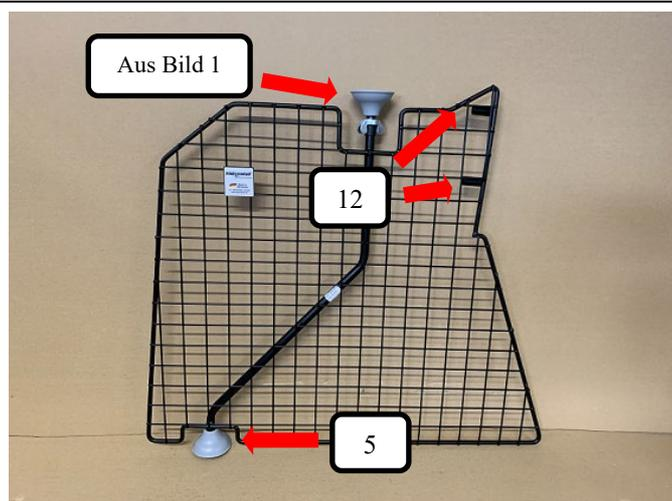
Wie im Bild dargestellt bitte die aus Bild 1 zusammengesteckte Gewindestange mit Gummifuß oben in die Rohröffnung des Teilers stecken (Feststellpunkt) und einen Gummifuß (Pos.5) unten am Teiler aufstecken. Beide Rohrendkappen (Pos. 12) auf den Teiler (Pos. 1) drücken.
