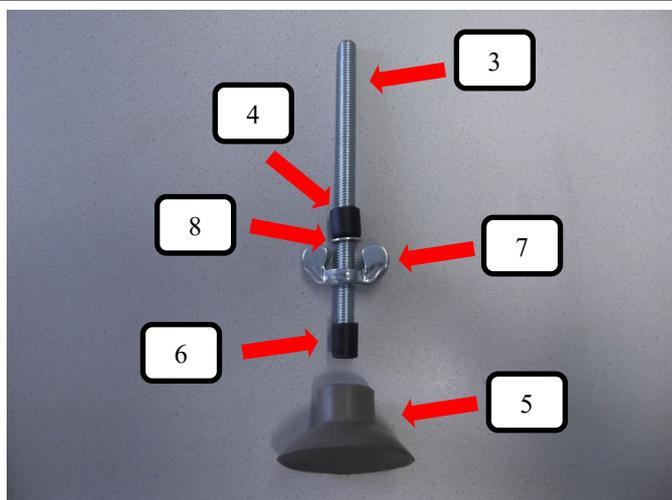
Die Gewindestange oben (Pos.3) auf einen Gummifuß grau (Pos.5) wie im Bild dargestellt aufstecken. Danach die Flügelmutter (Pos. 7) drauf drehen und die Unterlegscheibe (Pos. 8), sowie die Distanzhülse (Pos. 6) aufstecken.
