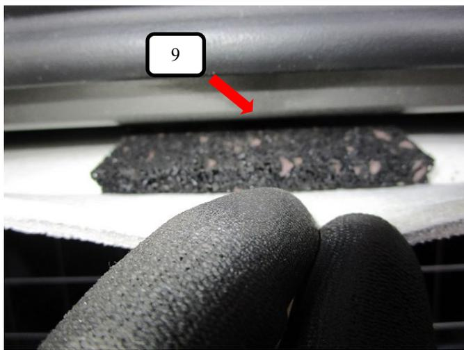
Im oberen Bereich der Hecktür die Gummiabdichtung leicht anheben und je nach gewünschter Position des Teilers 2 x die Gummimunterlagen 8mm (Pos.9) im Bereich des Feststellpunktes in den Hohlraum schieben.
