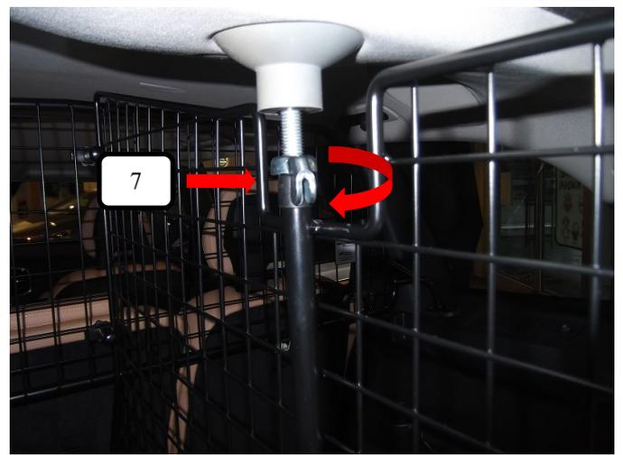
Oberen Feststellpunkt über drehen der Flügelmutter (Pos. 7) (Uhrzeigersinn) leicht anziehen.
