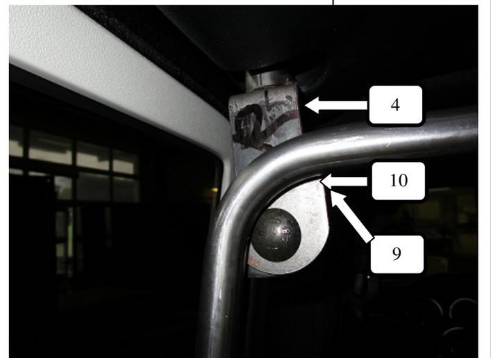
Oben im Dachbereich jeweils re. und li. die im Fahrzeug befindlichen Schrauben entfernen, und die beiden Dachhalter (4) entsprechend der Markierungen an dieser Stelle mit der Maschinenschraube (9) und der Unterlegscheibe (10) befestigen. **Hierzu wird ein 10er Steckschlüssel benötigt**
