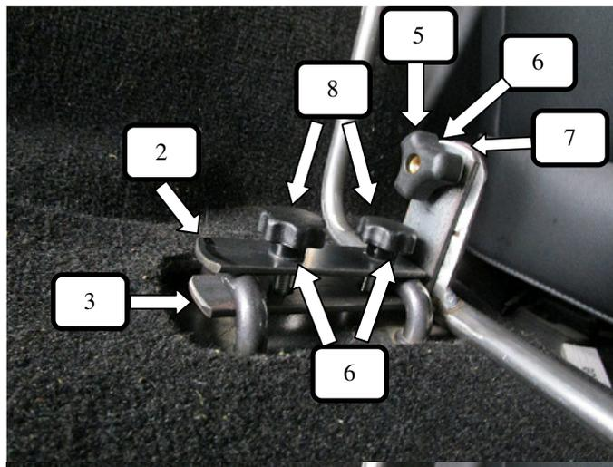
Trenngitter ins Fahrzeug einbringen, Bodenwinkel (3) jeweils re. und li. unter die Sitzverankerung schieben und mit Hilfe der Bodengegenstücke (2) an den Bodenwinkel (3) mittels Unterlegscheibe (6) und Rändelschraube (8) lose befestigen. Gitter mit Schlossschraube (7), Unterlegscheibe (6) und Rändelmutter (5) lose am Bodenwinkel (3) befestigen.
