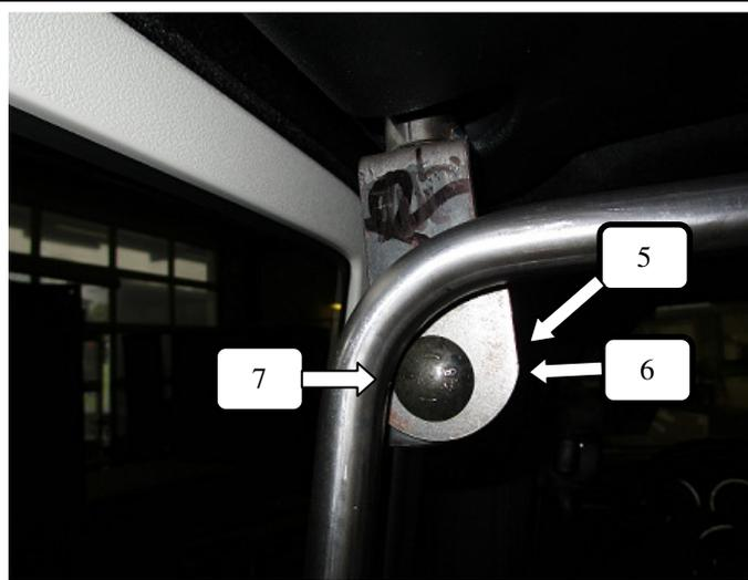
Nun das Gitter an beiden Seiten oben am Dachhalter mit einer Schlossschraube (7), Unterlegscheibe (6) und Rändelmutter (5) lose befestigen.
