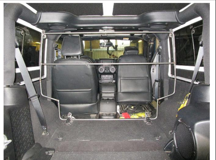
Das Gitter final ausrichten und an allen Positionen richtig befestigen.
