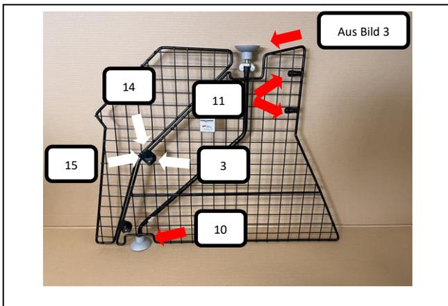
Wie im Bild dargestellt, bitte die aus Bild 3 zusammengesteckte Gewindestange mit Gummifuß oben in die Rohröffnung des Teilers (Pos. 1) stecken (Feststellpunkt) und einen Gummifuß (Pos.10) unten am Teiler aufstecken. Beide Rohrendkappen (Pos. 11) auf den Raumteiler drücken. Den Aufsatz (Pos. 13) an allen 3 Positionen, mittels einer Schlossschraube (Pos. 14), Unterlegscheibe M8 (Pos. 3) und Rändelmutter flach (Pos. 14) befestigen und festziehen.
