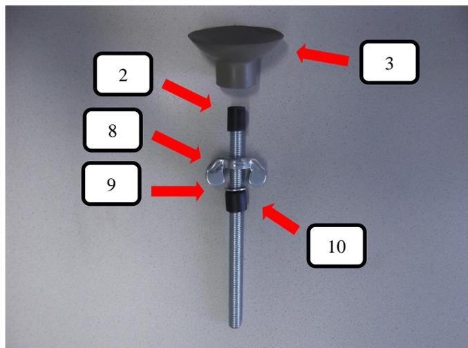
Die Gewindestange oben (Pos.2) auf einen Gummifuß grau (Pos.3) wie im Bild dargestellt aufstecken. Danach die Flügelmutter (Pos. 8) aufschrauben und die Unterlegscheibe (Pos. 9), sowie die Distanzhülse (Pos. 10) aufstecken.
