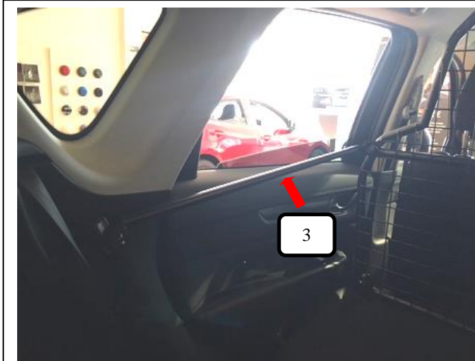
Streben links + rechts (Pos. 3) im montierten Zustand.
