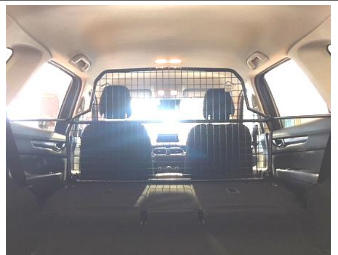
Trenngitter (Pos. 1) im montierten Zustand.
