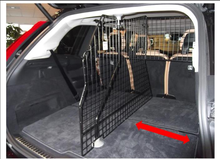
Teiler ggf. leicht ausrichten und final befestigen.
