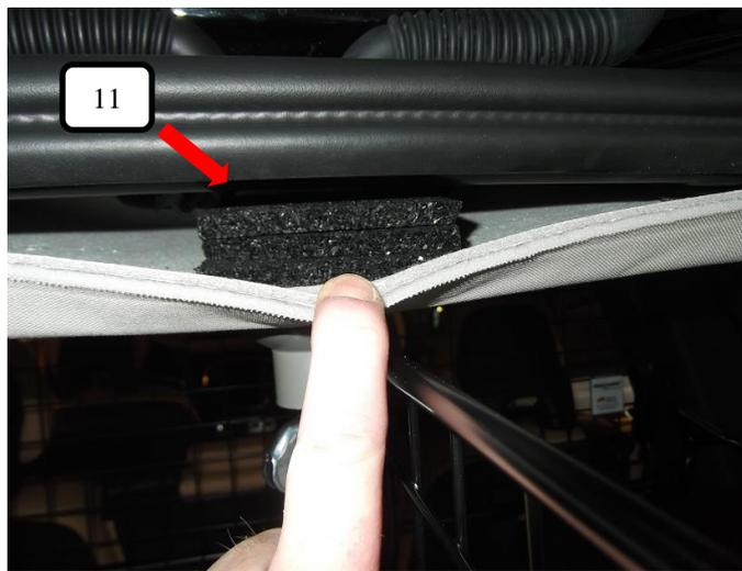
Im oberen Bereich der Hecktür die Gummiabdichtung leicht anheben und je nach gewünschter Position des Teilers die Gummiunterlagen 8mm (Pos.11) im Bereich des Feststellpunktes in den Hohlraum schieben.
