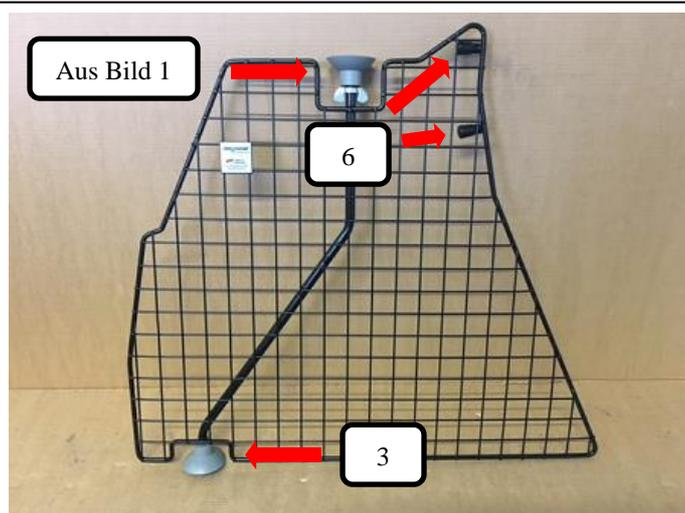
Wie im Bild dargestellt bitte die aus Bild 1 zusammengesteckte Gewindestange mit Gummifuß oben in die Rohröffnung des Teilers stecken (Feststellpunkt) und einen Gummifuß (Pos.3) unten am Teiler aufstecken. Beide Rohrendkappen (Pos. 6) auf den Teiler (Pos. 1) drücken.
