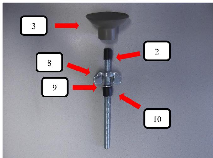
Die Gewindestange oben (Pos.2) auf einen Gummifuß grau (Pos.3) wie im Bild dargestellt auf stecken. Danach die Flügelmutter (Pos. 8) drauf drehen und die Unterlegscheibe (Pos. 9), sowie die Distanzhülse (Pos. 10) aufstecken.
