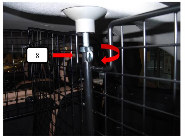
Oberen Feststellpunkt über drehen der Flügelschraube (Uhrzeigersinn) leicht anziehen.
