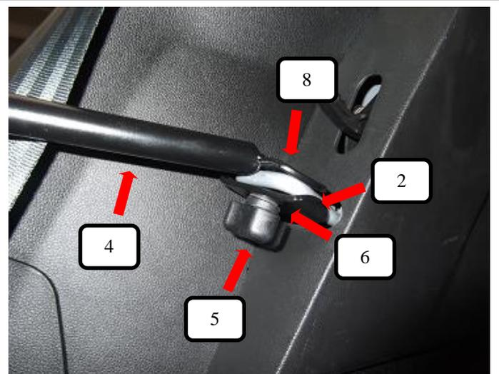
Streben lang (links + rechts) (Pos. 4) auf die Rücksitzbankverankerung legen und von oben die Schlossschraube (Pos. 8) durchstecken, von unten die Gegenplatte (Pos. 2) dranhalten und dann mit der Unterlegscheibe (Pos. 6) und der Rändelmutter flach (Pos. 5) eindrehen und anziehen.
