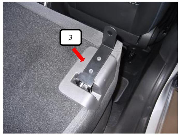
Winkel Boden (Pos. 3) in die Rückensitzlehnen-Verankerung drücken, bis sie einrastet.
