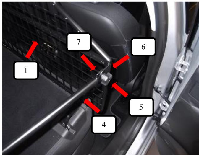
Strebe lang (links + rechts) (Pos. 4) von innen an das Trenngitter (Pos. 1) halten und von der Innenseite die Schlossschraube (Pos. 7) durchstecken, von außen mit der Unterlegscheibe (Pos. 6) und der Rändelmutter flach (Pos. 5) eindrehen und anziehen.
