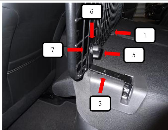
Trenngitter (Pos. 1) von der Seitentür aus in das Fahrzeug reinheben und vor den Winkel Boden (Pos. 3) stellen. Jetzt von vorne die Schlossschraube (Pos. 7) durchstecken, dann von der anderen Seite mit der Unterlegscheibe (Pos. 6) und der Rändelmutter flach (Pos. 5) eindrehen und anziehen.
