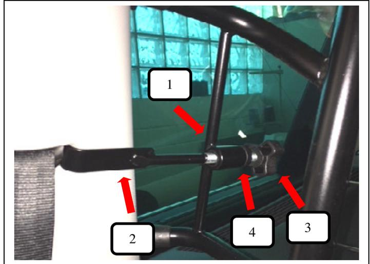
Trenngitter (Pos. 1) von hinten in das Fahrzeug einbringen und gegen die C-Säule stellen. Gewindehaken (Pos. 2) in die Gurtaustrittsöffnung einhängen und durch die Kunststoffhülse (Pos. 4) im Trenngitter (Pos. 1) führen, die Rändelmutter (Pos. 3) aufschrauben und festziehen.
