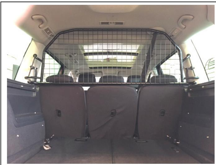
Trenngitter (Pos. 1) im montierten Zustand.
