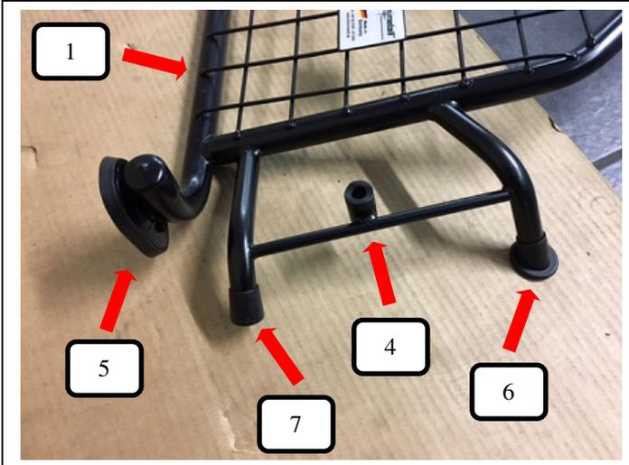
Gummifuß (Pos. 5), Rohrendkappe 16mm (Pos. 7), Schutzkappe 25° (Pos. 6) auf das Trenngitter (Pos. 1) und Kunststoffhülse (Pos. 4) in das Trenngitter (Pos. 1) stecken.
