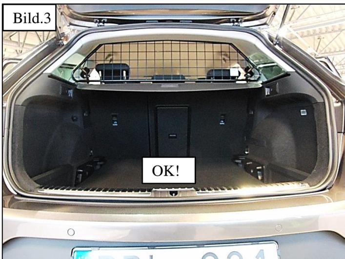
Trenngitter vorsichtig in das Fahrzeug bringen, und mit den Gummiauflagen am Fensterrahmen ausrichten. Gewindehaken Pos.7 über die Rückenlehnenverankerung schieben und die Gewindestange durch die Hülse am Trenngitter stecken. Rändelmutter Pos. 2 auf die Gewindestange schrauben, bis das Trenngitter spielfrei sitzt. Rückenlehnen wieder einrasten.
