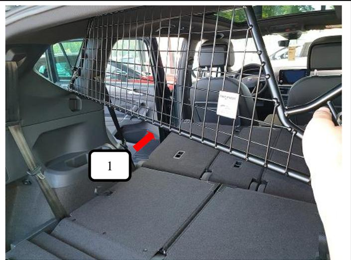
Trenngitter (Pos. 1) wie auf dem Bild von hinten aus in das Fahrzeug einbringen.
