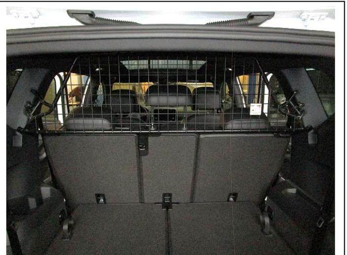
Trenngitter im montierten Zustand.
