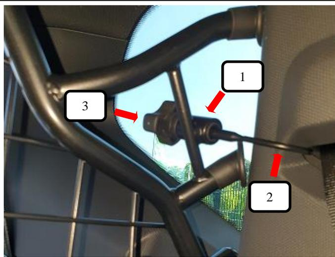
Gewindehaken (Pos. 2) in den Gurtaustrittsöffnung einhängen und durch das Trenngitter (Pos. 1) führen. Rändelmutter gewölbt (Pos. 3) auf den Gewindehaken (Pos. 2) aufschrauben und festziehen.
