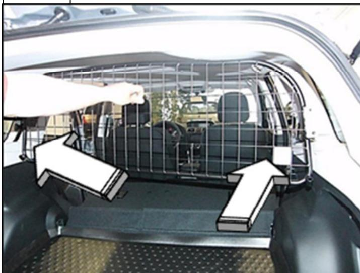
Trenngitter in das Fahrzeug einbringen.
