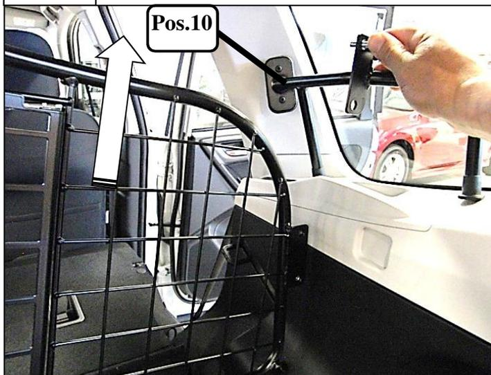
Rechte Abstützung Pos.10 am Trenngitter montieren.
