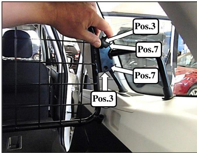
Die Montage der rechten Seite genauso wie auf der linken Seite (siehe Bild 2) durchführen. Schutzkappen Pos.6 so drehen, dass sie gleichmäßig an den Seitenverkleidungen anliegen.
