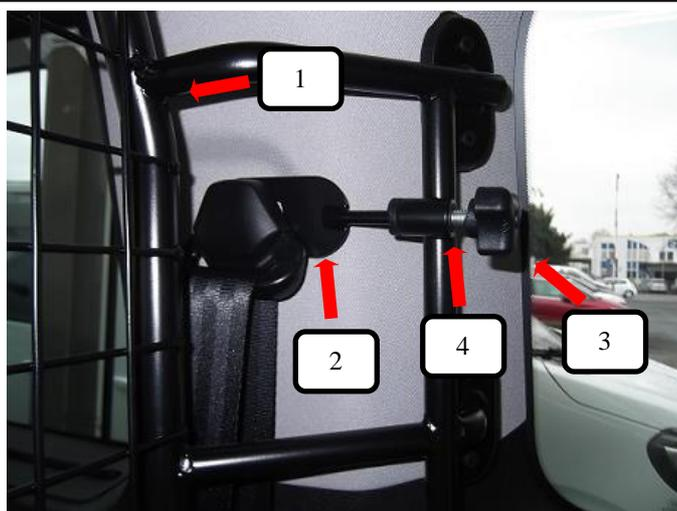
Trenngitter (Pos. 1) von hinten an die C-Säule halten, dann den Gewindehaken (Pos. 2) durch das Trenngitter (Pos. 1) und die Kunststoffhülse (Pos. 4) schieben. Mit der Rändelmutter gewölbt (Pos. 3) festziehen.
