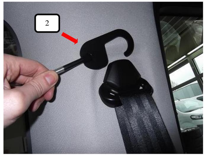
Gewindehaken (Pos. 2) hinter den Gurt rechts und links einhängen.
