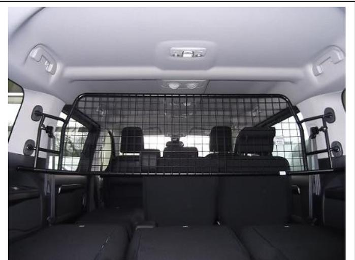
Trenngitter (Pos. 1) im montierten Zustand.
