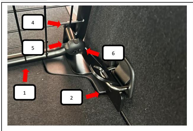
Bodenhalter L+R (Pos. 2) wie auf dem Bild in die ausgeklappte Verzurösen einhängen, jetzt von hinten aus das Trenngitter (Pos. 1) in den Kofferraum einbringen und auf die Bodenhalter L+R (Pos. 2) stellen. Nun von vorne jeweils eine Schlossschraube M8x45 (Pos. 4) durch den Bodenhalter L+R (Pos. 2) und das Trenngitter (Pos. 1) stecken. Von der anderen Seite eine Unterlegscheibe M8 (Pos. 5) und Rändelmutter gewölbt (Pos. 6) aufschrauben und festziehen.
