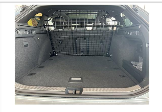
Trenngitter im montierten Zustand.
