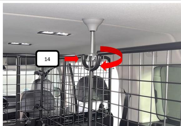
Beide oberen Feststellpunkte über drehen der Flügelmutter (Pos. 14) (Uhrzeigersinn) leicht anziehen.
