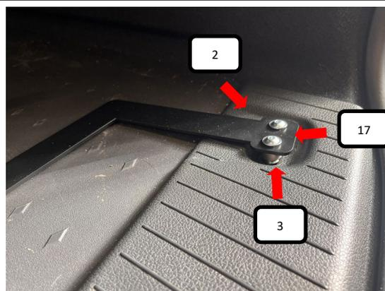
Verzurrösen rechts und links entfernen. Jetzt die Distanzhülsen (Pos. 3) über die Gewindelöcher legen, die Bodenschiene abgewinkelt (Pos. 2) darüberlegen und nun mit den Innensechskantschrauben (Pos. 17) befestigen und festziehen.
