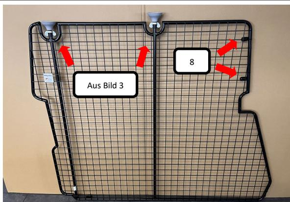
Wie im Bild dargestellt, bitte die aus Bild 3 zusammengesteckte Gewindestangen mit Gummifuß oben in die Rohröffnungen des Raumteilers stecken (Feststellpunkt).
