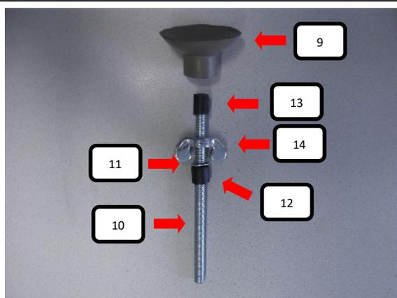
Auf die Gewindestange oben (Pos. 10) die Distanzhülse (Pos. 13) und danach den Gummifuß (Pos. 9) aufstecken. Von der anderen Seite die Flügelmutter (Pos. 14) aufdrehen und dann die U-Scheibe (Pos. 11) und Durchführungsschutzkappe (Pos. 12) aufschieben. Das ganze 2 x vormontieren.
