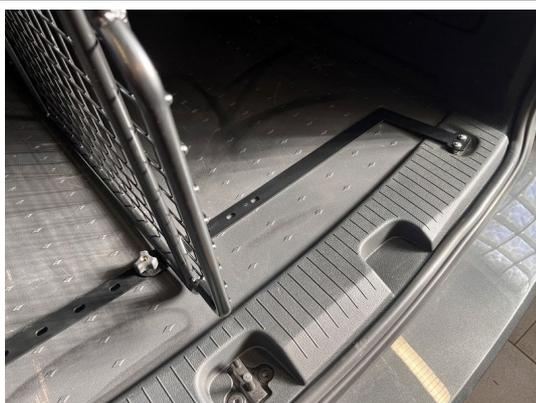
Jetzt den Raumteiler (Pos. 1) in das Fahrzeug einbringen. Von unten durch die Bodenschiene abgewinkelt (Pos. 2) eine Schlossschraube M8x20 (Pos. 15) an der gewünschten Position stecken und von oben den Raumteiler (Pos. 1) darüber stellen. Jetzt eine Unterlegscheibe (Pos. 9 und Rändelmutter flach (Pos. 4) aufschrauben und festziehen.
