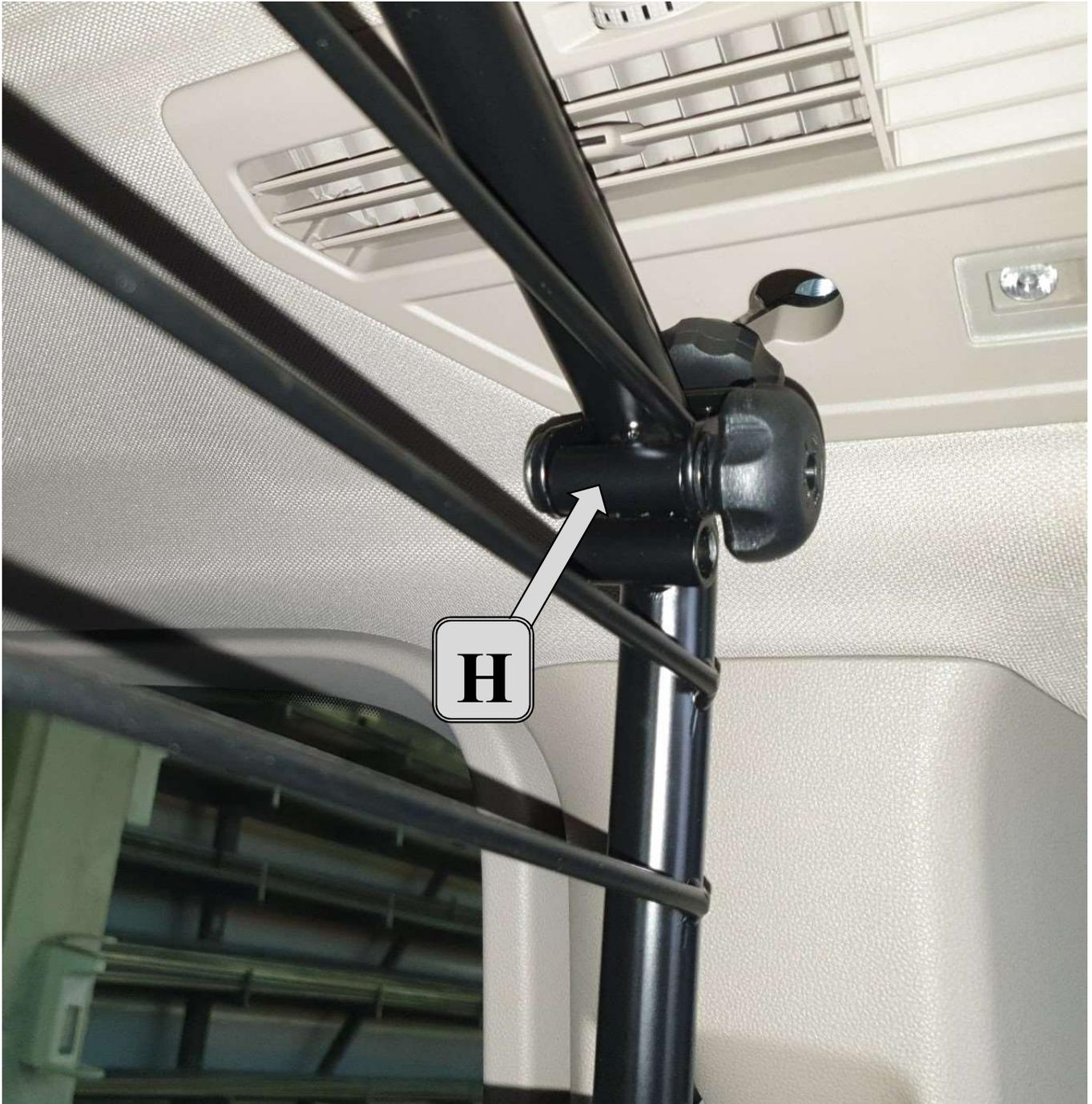
Die Montage des Trenngitters hinter der Rücksitzbank unterscheidet sich nur in den Montagepunkten der Dachverankerung Pos.6 am Trenngitter (H-> obere Hülse) und der Position der Montagebügel Pos.2 in der Bodenschien.
