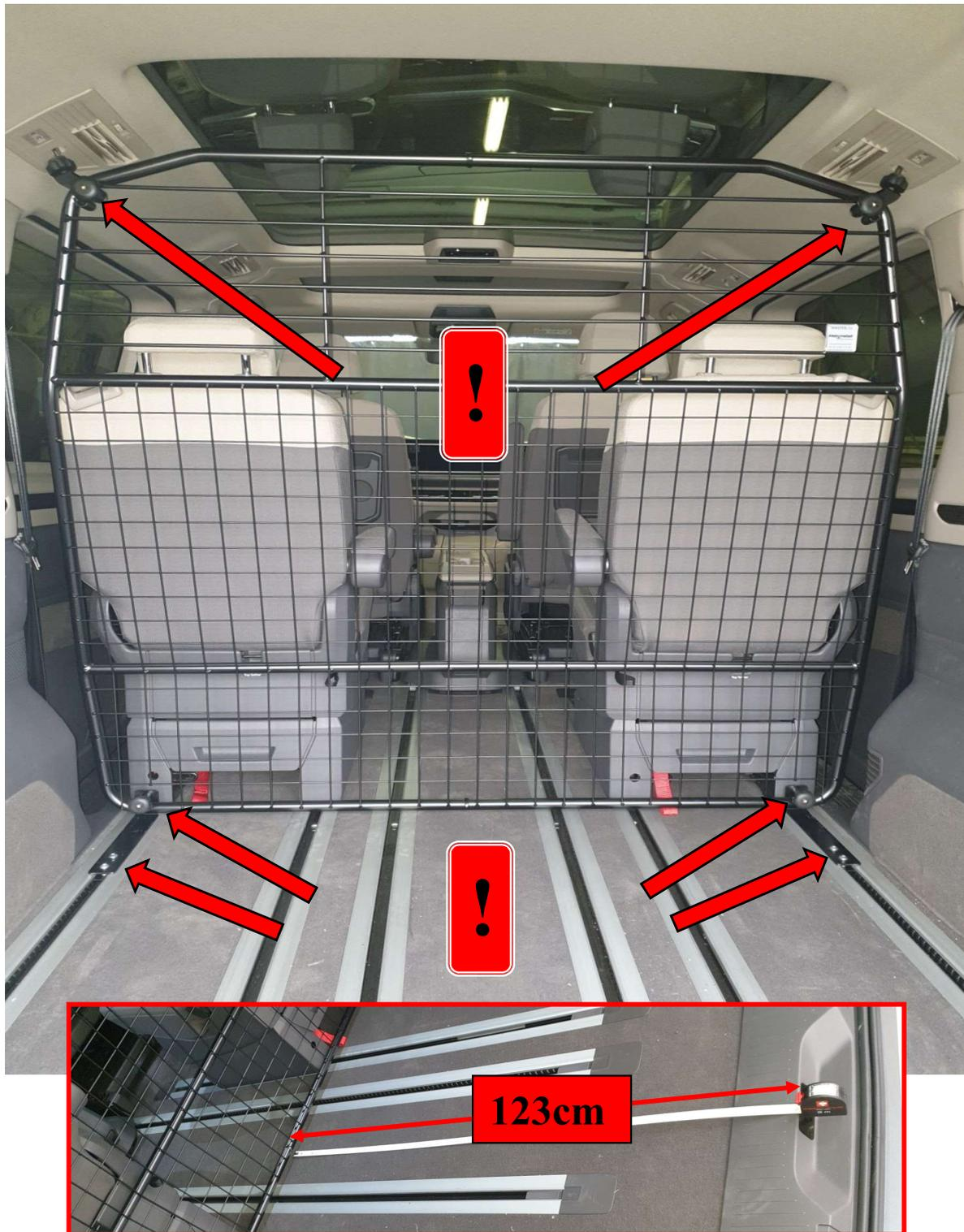
**Der Abstand des Trenngitters bis zur Heckklappenverriegelung sollte ca. 123cm betragen.**
