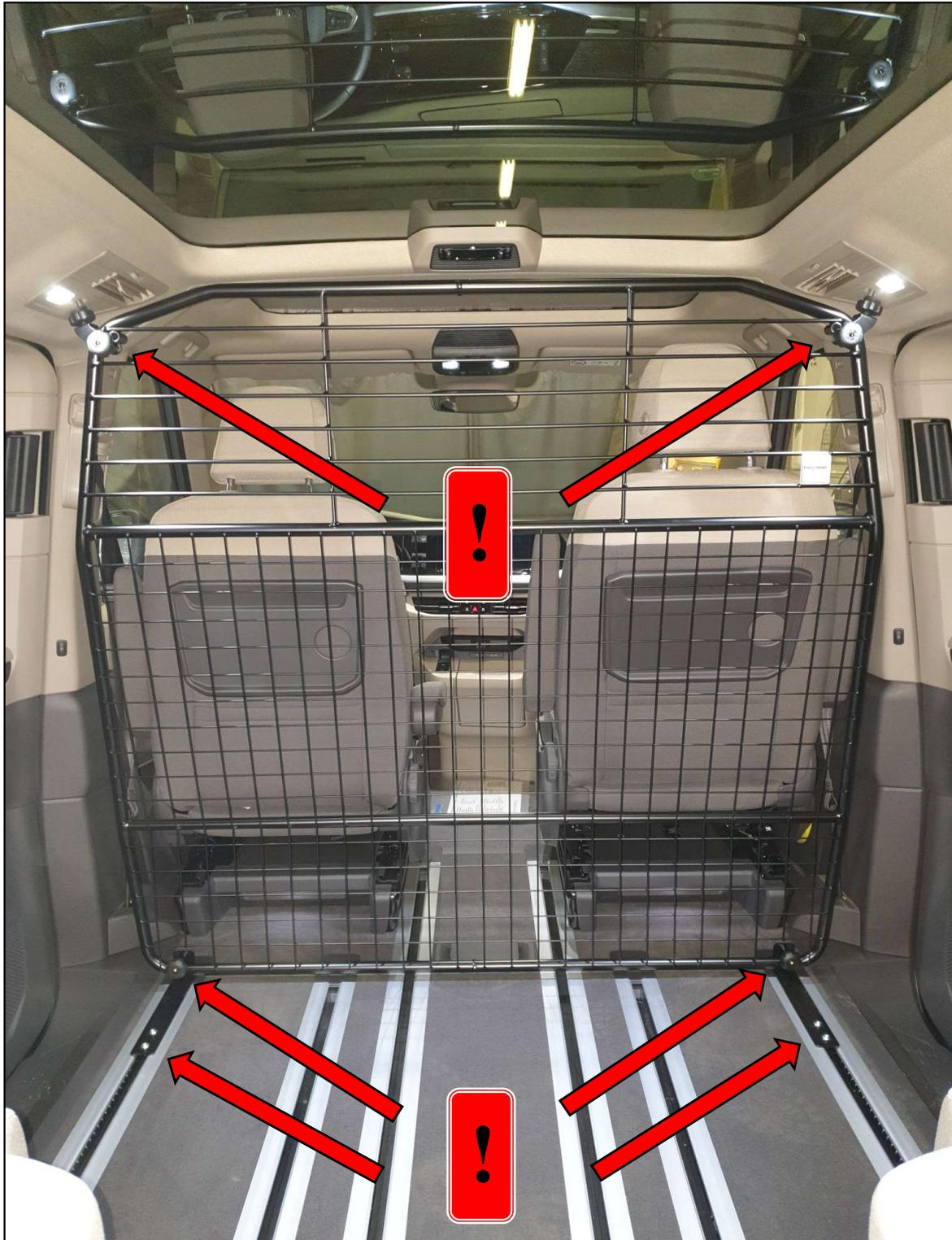
**Trenngitter gleichmäßig ausrichten und alle Verschraubungen anziehen.**
