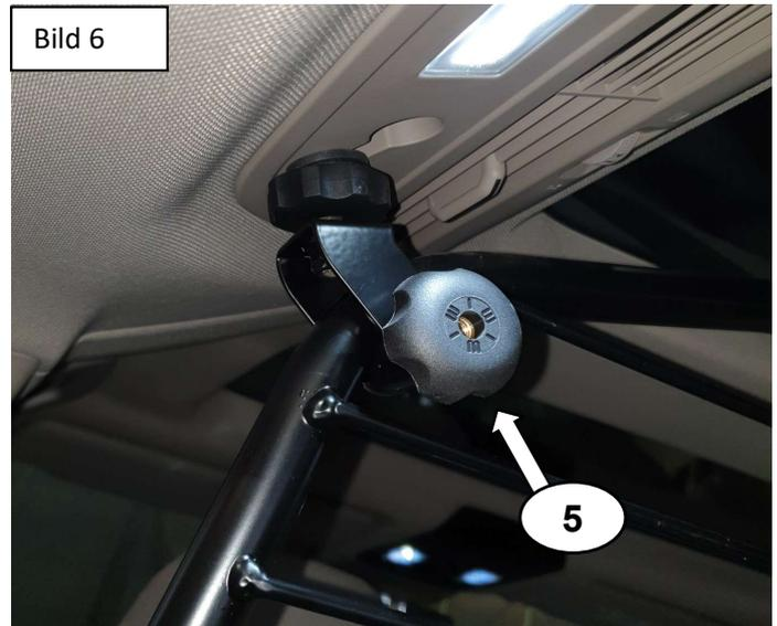
Trenngitter Pos.1 in das Fahrzeug vorsichtig einbringen und Dachhalterung Pos.6 mit Schlossschraube Pos. 4, U-Scheibe Pos. 3 und Rändelmutter Pos.5 an die untere Hülse am (V-hinter den Vordersitzen) montieren.
