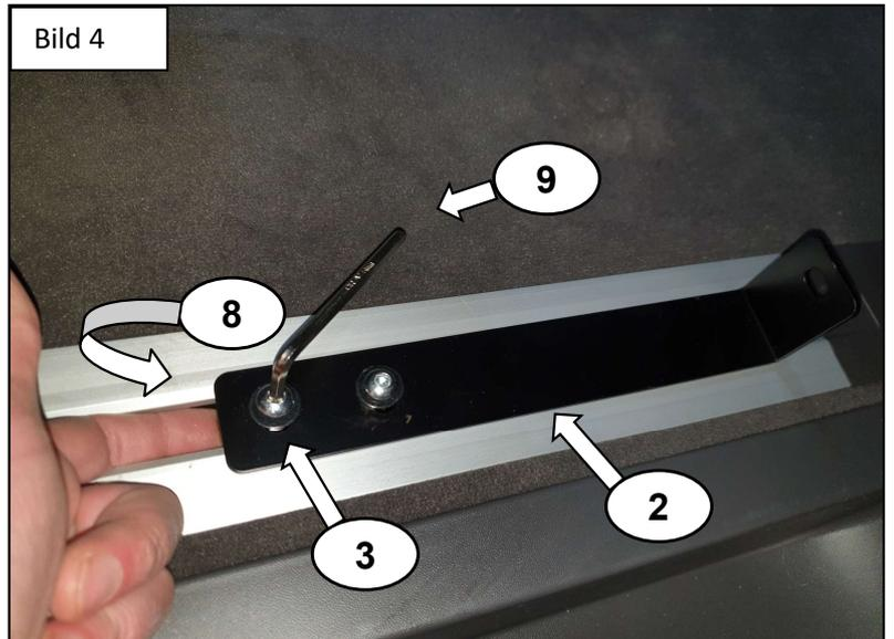
Ankerplatten Pos.8 in die Bodenschienen einschieben und darauf achten das sie in der Verzahnungen der Schienen sitzen. Montagebügel Pos.2 mit Inbusschrauben Pos. 7 und U-Scheiben Pos.3 an Ankerplatten Pos.8 lose verschrauben. Zum einfacheren ansetzen der Inbusschrauben Pos.7, die Ankerplatten Pos.8 mit den Finger in den Schienen etwas anheben.
