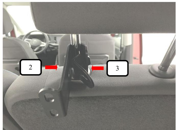
Winkelstütze (Pos. 2) wie auf dem Bild um die Kopfstützenstangen führen, jetzt die Winkelstütze (Pos. 3) in die Winkelstütze (Pos. 2) einklinken.
