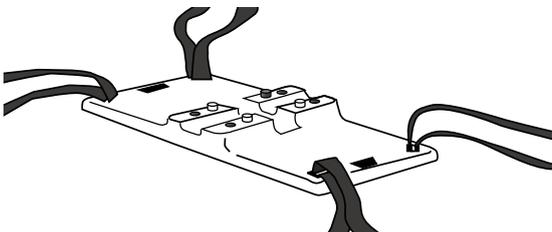
**10** Montage Bodenplatte - Teiler
