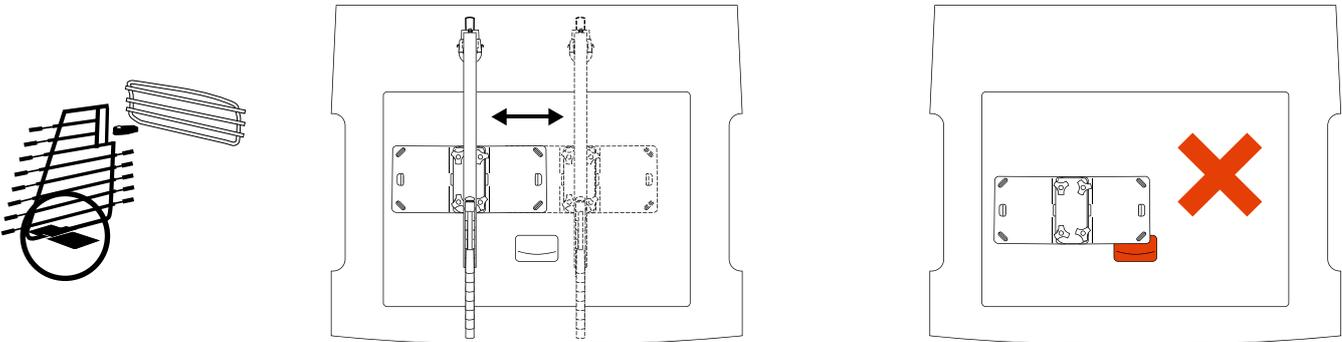
**8** Befestigungsmöglichkeiten mit Spanngurten
